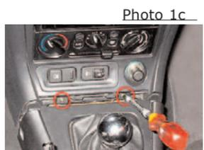
(cf. photo 2c), leur dégrafage doit être très minutieux pour ne pas endommager l'entourage en tirant trop fortement : La bonne technique consiste à commencer par celle située en bas à gauche (photo 1d), de tirer fermement mais sans mouvement brusque au niveau de l'agrafe jusqu'à ce qu'elle se libère. Passez ensuite aux agrafes suivantes en tournant dans le sens des aiguilles d'une montre pour finir par celle
