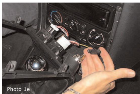
La console est encore reliée par les câbles électriques des différents boutons et l'allume-cigare (photo 1e). Débranchez-les.
