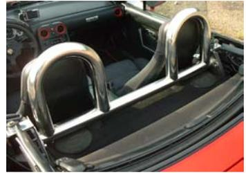
Placer le style bar sur les têtes de ceintures, fixer les vis d'origine et les vis arrières dans les trous que vous avez percés, remettre les caches ceinture et hop, c'est fait.
